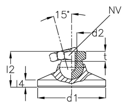
d1 = 32 d2 = 8 l2 = l4 = -NV = 12 Static load (kN) = 10 t min = 9
